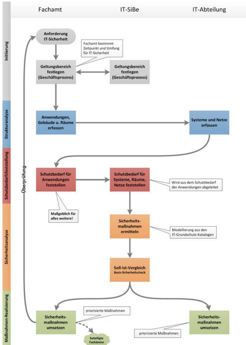
Abbildung 2: Phasen und Zuständigkeiten bei der Erstellung und Umsetzung eines IT-Sicherheitskonzepts<sup>33</sup>
