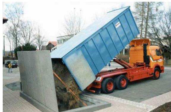
Abbildung 6: Bevorratung eines Holzhackschnittelsilos
