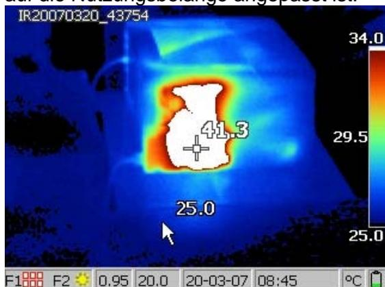
Abb.8: Infrarotaufnahmen - Warmer Abluftstrom eines Druckers „heizt“ ein Büro mit auf (Quelle: Energiemanagement, Stadt Freiburg)
