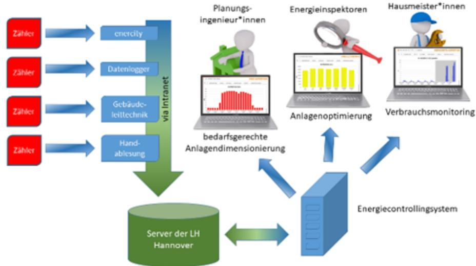
Abb. 6: Aufbau Energiecontrollingsystem LH Hannover
