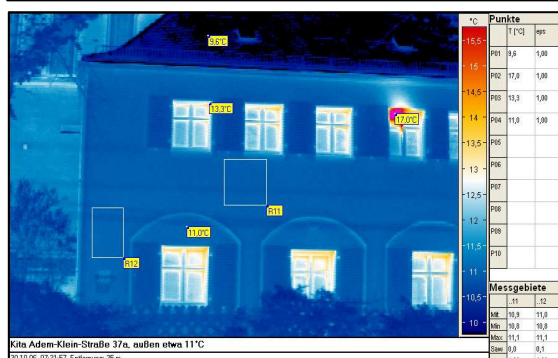
Abb. 6 u. 7: Stadt Nürnberg: Thermographieaufnahmen einer Kindertagesstätte vor und nach der Sanierung
