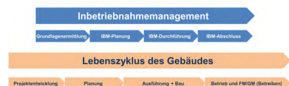
Abbildung 2: IBM Aufbau nach VDI 6039, wiedergegeben mit Erlaubnis des Vereines Deutscher Ingenieure e. V.
